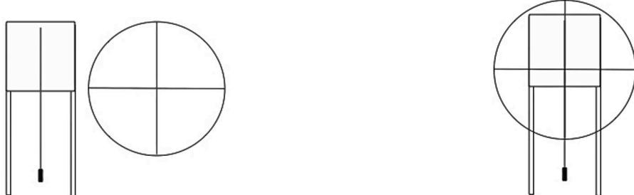
Poggeremo l'ottica sui suoi anelli di supporto e, prima di serrarla, traguarderemo la linea verticale del suo reticolo con il filo a piombo sino ad aggiustarla nella posizione corretta. Poi, controllando ad ogni serraggio, sia l'allineamento del reticolo con il filo a piombo, sia la tenuta in bolla della carabina, la bloccheremo sui suoi supporti.
