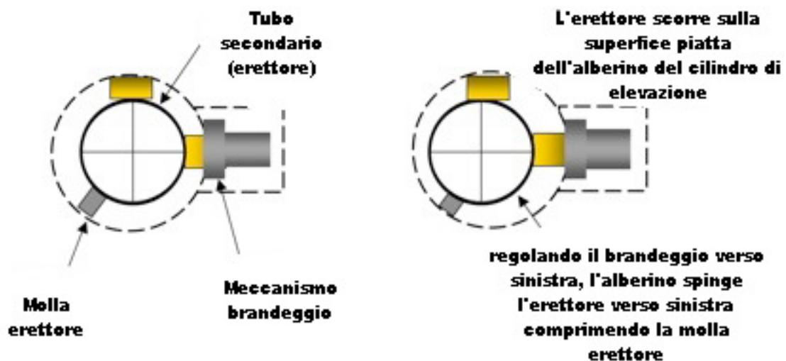
A questo punto si comprende quanto sia importante, nel gioco delle regolazioni, la molla dell'erettore. Se resa troppo debole dall'usura o da una compressione continua, esercitata dall'erettore, può non operare regolarmente come contrasto all'azione di controllo delle due torrette. Ruotando i cilindri di regolazione si percepiscono dei "click fantasma", in quanto il meccanismo interno non risponde correttamente.
