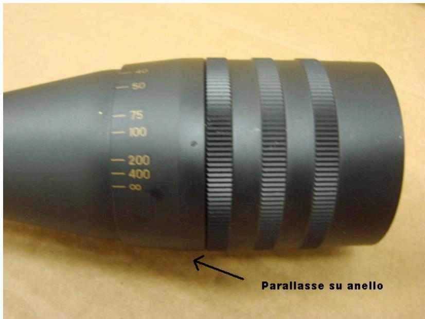
L'utilizzo di tale funzione di controllo deriva dal fatto che l'immagine di destinazione e il reticolo non sono focalizzati sullo stesso piano. Nelle ottiche a basso gradiente di ingrandimenti l'errore di parallasse non costituisce un grande problema, differente invece è per le ottiche in cui gli ingrandimenti sono elevati. In questo ultimo caso l'errore va necessariamente compensato.
