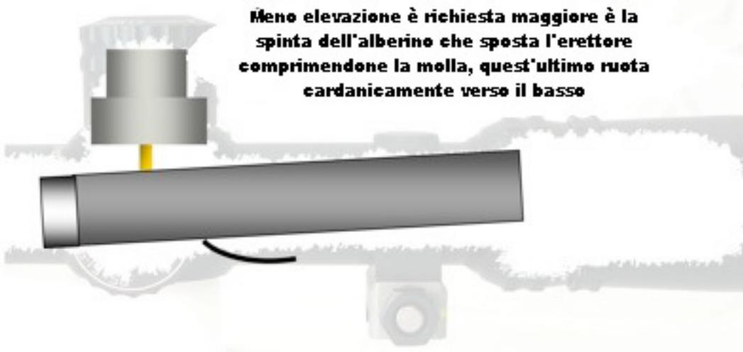
Guardando lo spaccato interno dell'ottica dal lato del suo oculare, si può vedere come l'azione di contrasto dell'alberino, comandato dal cilindro rotante del sistema di brandeggio, comprima o allenti la molla dell'erettore, permettendo lo spostamento verso destra o sinistra dell'erettore stesso. Non dimentichiamo che l'erettore è
